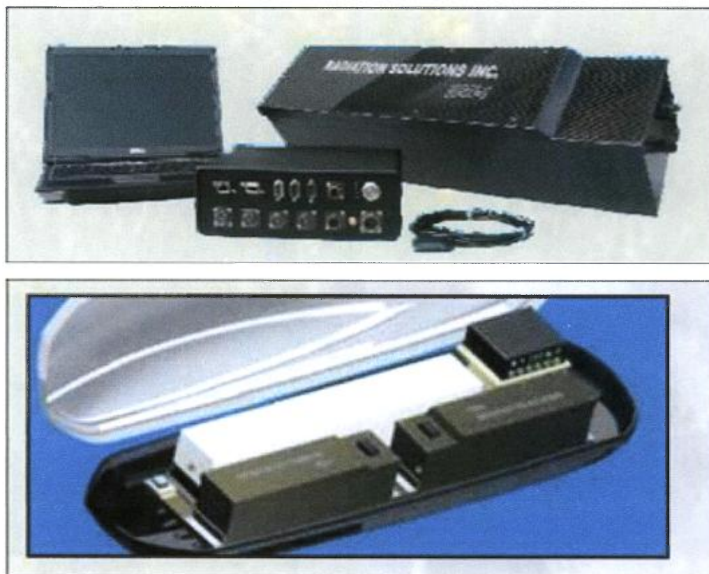
Figure 4. Système spectrométrique gamma mobile RS-700 de la compagnie Radiation Solutions inc. utilisé dans le cadre de ce projet.
