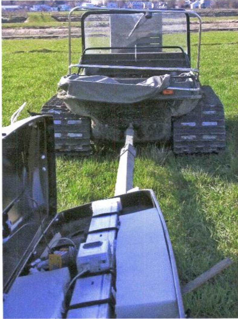
Figure 11. Remorque de l'INRS-ÉTÉ utilisée pour le levé de conductivité électrique mobile (Sonde GEM2 de Geophex et DGPS Max de CSI-Hemisphere inc. ).
