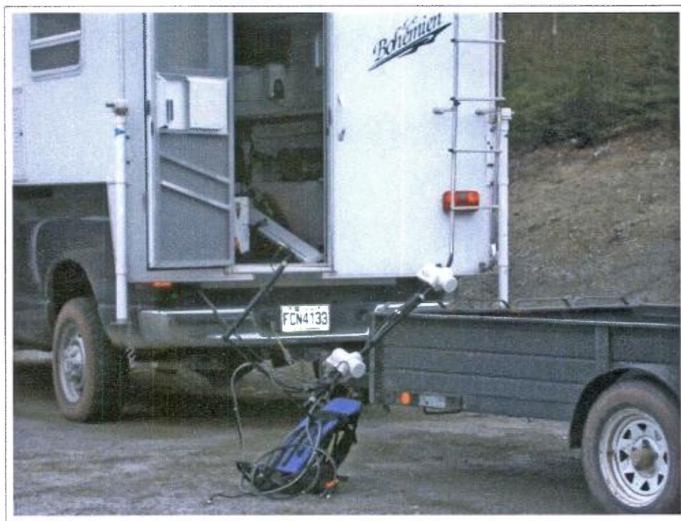
Figure 8. Magnétomètre utilisé pour le levé géophysique sur la propriété Charlevoix (secteur de Baie-St-Paul).
