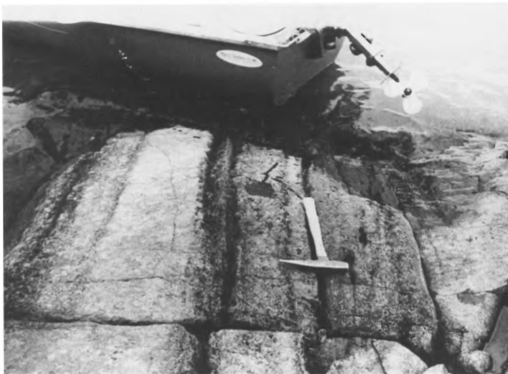
FIGURE 39 - Deux affleurements de la sous-zone péridotitique, sur la grève d'une île du lac David. Les bandes pâles sont des lits d'anorthosite et les bandes foncées, des lits de péridotite constitués de serpentine, trémolite, magnétite et carbonates.
