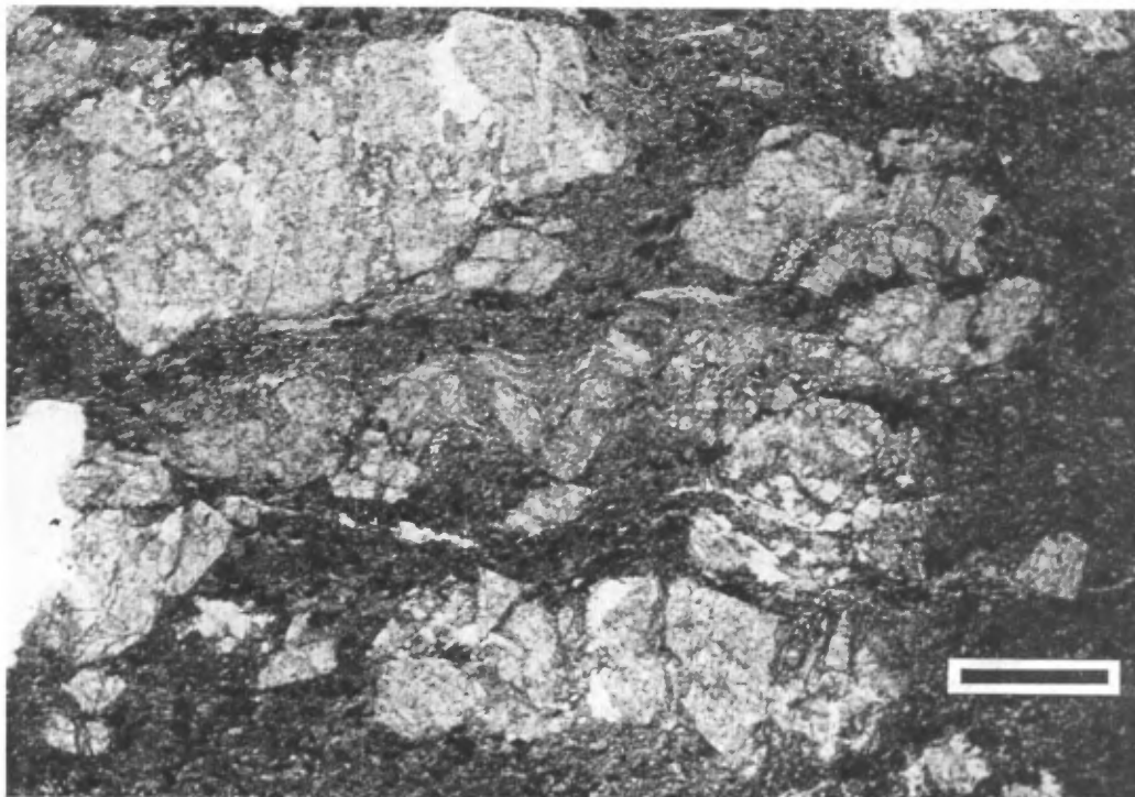
FIGURE 136 – Microphotographie d'un tuf à cristaux de plagioclase qui a subi les effets de la déformation régionale. Formation de Waconichi, secteur Richardson (L.N., la barre noire fait 0,5 mm).
