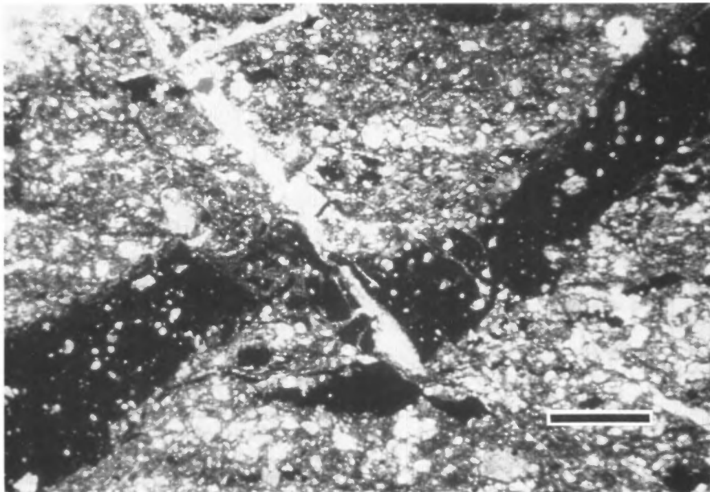
FIGURE 190 - Microphotographie des mylonites de la faille Mistassini montrant une injection de pseudotachylite. Le matériel vitreux d'origine est remplacé par des oxydes de fer. Des morceaux d'épontes baignent dans le matériel vitreux. La barre noire fait 1 mm.
