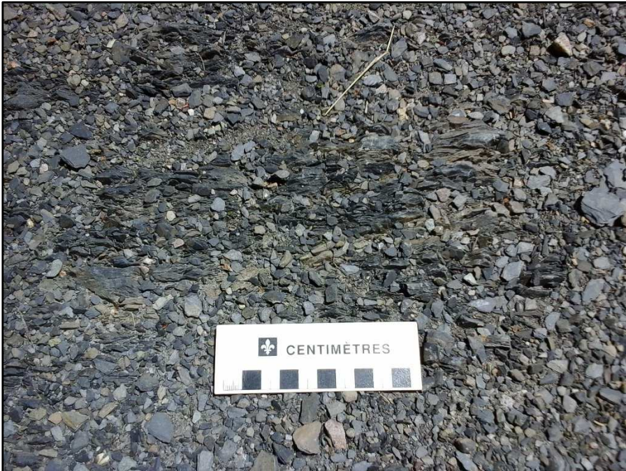
PHOTO 8 - Mudstone noir non calcaireux à fort clivage directement en dessous du Val-Brillant; affleurement 16-RT-4607.
