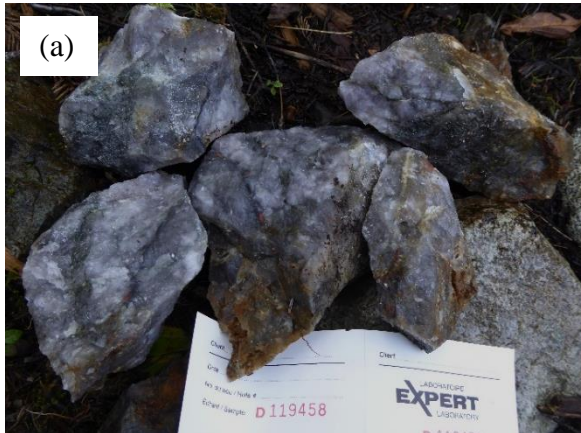
Figure 20 : (a) Photo de l'échantillon #D119458 montrant une veine de Qz-Fk à bordure diffuse et contenant des traces de pyrite; (b) Photo de l'échantillon #D119460 minéralisé à 4 % Py et traces Mo; (c) Photo de l'échantillon #D119462 montrant des injections de Qz-Cc-Py dans une rhyodacite; (d) Photo de l'échantillon #D119485 montrant une veine de spécularite massive
