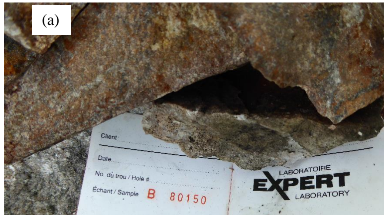
Figure 15 : (a) Photo de l'échantillon #B80150 montrant une minéralisation à 4 % de pyrite dans une roche fortement carbonatisée et hématisée; (b) Photo de l'échantillon #F20259 montrant une minéralisation à 5 % de pyrite dans une rhyolite hématisée et carbonatisée; (c) Photo de l'échantillon #F20333 montrant une veine de Qz-CI-Fk minéralisée en pyrite et magnétite
