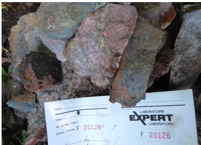
Figure 9 : Photo d'un échantillon (#F20126) altéré Hm-Ak avec Cl-Hs-Py dans les fines fractures sur la propriété Flavrian
