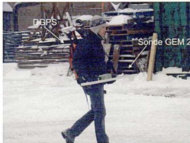
Figure 15. Sonde d'induction électromagnétique GEM-2 multifréquences, couplée à un système de positionnement DGPS sub-métrique.
