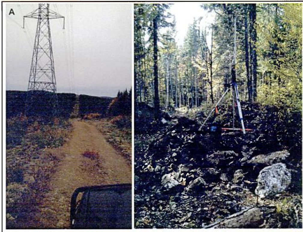
Figure 8. Installation de la station de base RTK au sommet de la ligne d'Hydro-Québec (A) et répéteur radio RTK installée près de la tranchée V de la propriété Roncevaux.
