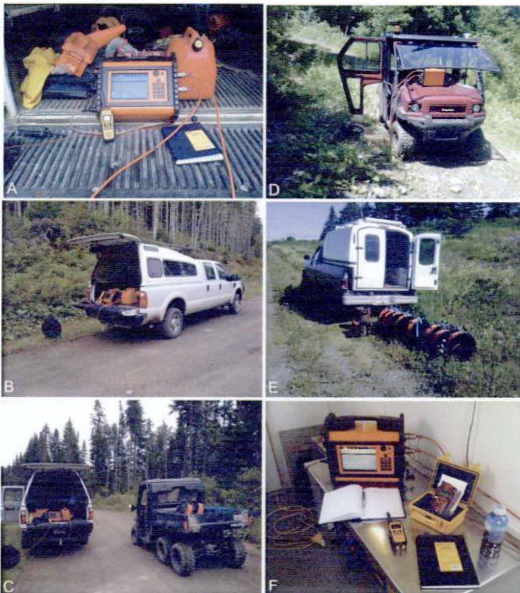
Figure 17. Photographies montrant les équipements utilisés pour un levé de résistivité électrique avec le système ABEM Terrameter-LS.
