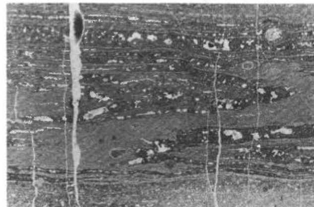
FIGURE 25 — Photomicrographie (X4,7) de la rhyolite de l'unité felsique supérieure à proximité de la perlite.
