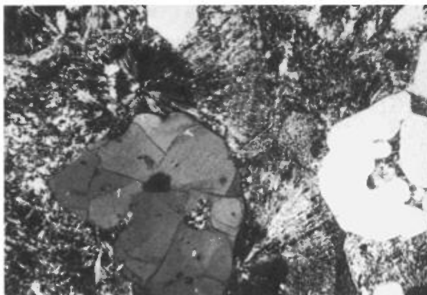
FIGURE 20 — Photomicrographie (X 24) du même tuf que celui de la figure 19 montrant des sphérolites accrochés aux phénocristaux.
