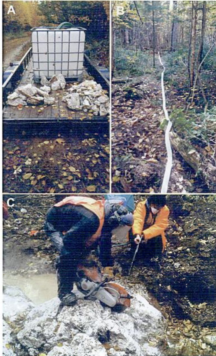
Figure 8. Photographies de terrain montrant un réservoir d'eau de 1000 litres (A), un boyau d'arrosage de haute capacité (B) et l'équipe technique lors d'un rainurage (C).
