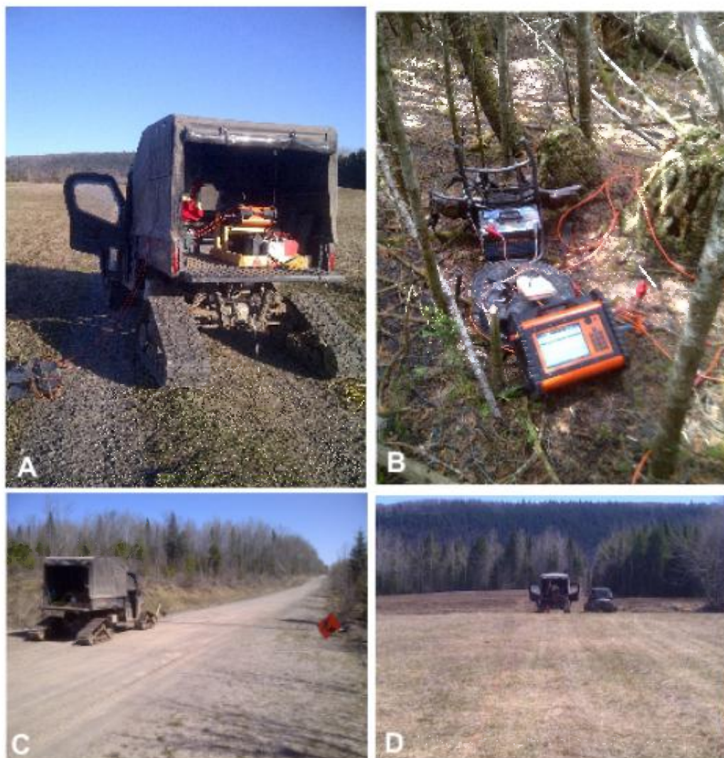
Figure 11-2. Photographies montrant les équipements utilisés pour le levé de résistivité électrique ABEM Terrameter-LS (mai 2013). A chenillette Polaris, B : Terrameter LS dans la forêt, C : protection du câble le long du chemin du rang 10 ( road guard ), D : Acquisition dans le champ de la ligne E.
