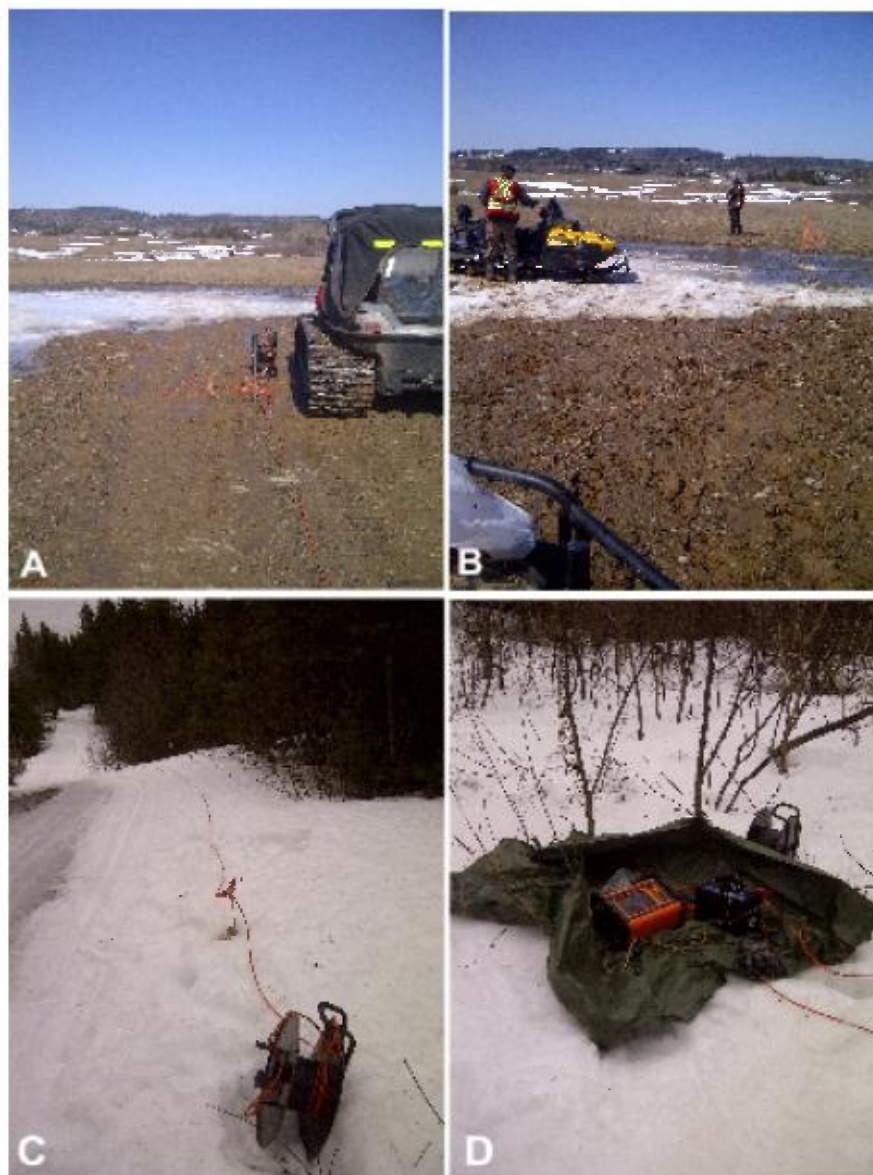
Figure 12. Photographies montrant les équipements utilisés pour le levé de résistivité électrique ABEM Terrameter-LS (avril 2013). A et B: dispositif le long de la ligne E; B: équipements dans la forêt, C : câble et électrodes le long de la ligne G; D: Terrameter LS dans une érablière.
